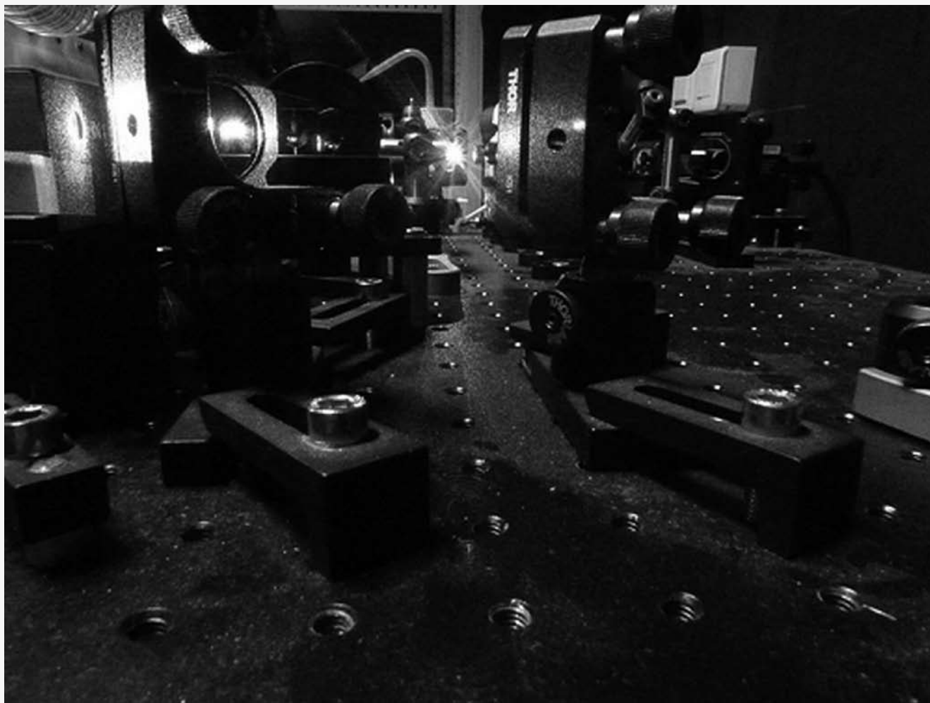
Système de réflecteurs (miroirs dichroïques) orientant les lasers vers le nanoscope et modulant leur intensité © Institut Pasteur © photo : Romy Raffin.
