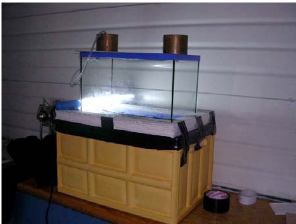
Chambre à brouillard
